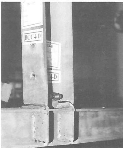
Fig. 12 - Modo de rotura para a ligação do tipo BCC4.
