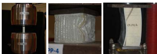
Fig. 2 – Ensaio dos laminados à tracção (à esquerda); ensaio de compressão transversal (ao centro); ensaio de compressão no plano (à direita).
