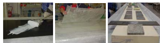
Fig. 1 – Diferentes fases da produção dos painéis sanduíche pela técnica de hand lay-up .
