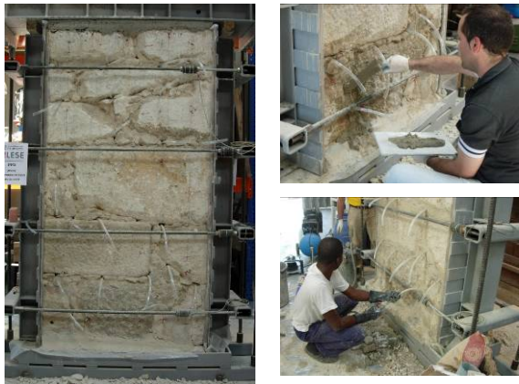
Fig. 21 – Injeção com argamassa na parede PP3
