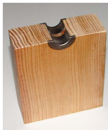
Fig. 6 – Peça central do provete reforçado com insertos metálicos – secção transversal.
