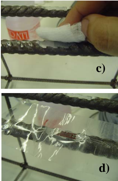
Fig. 9 – c) Limpeza da superfície; d) posicionamento do strain-gage .
