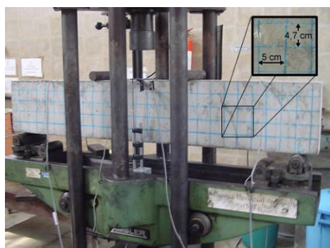
Fig. 13 – Demarcação de malha para mapeamento das fissuras.
