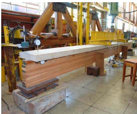
Fig. 9 – Arranjo de ensaio das vigas mistas.
