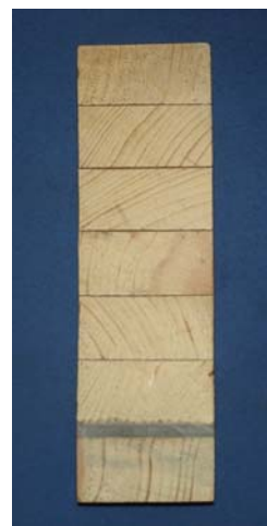
Fig. 1 – Seção transversal de viga de MLC reforçada com fibras de vidro.
