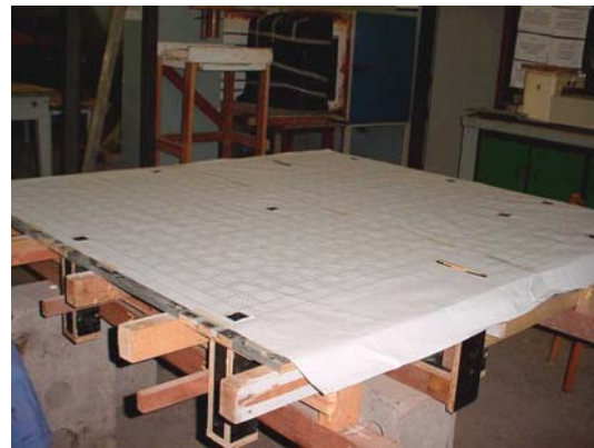
Fig 7 - Estrutura da fôrma do modelo reduzido
