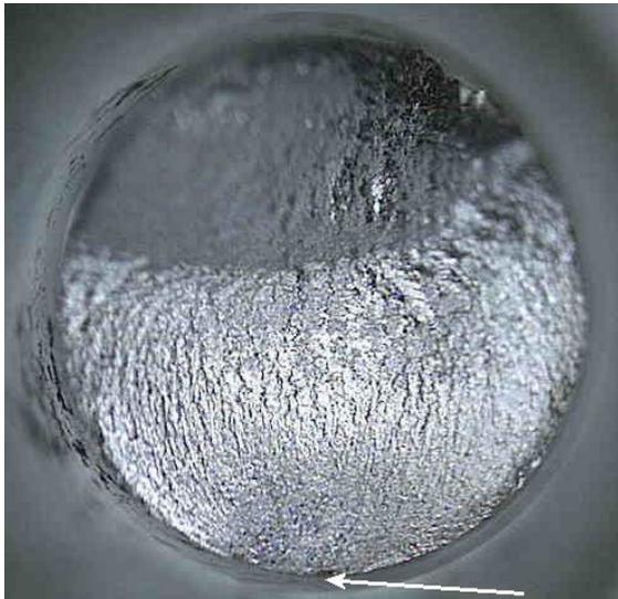
**Fig. 9** - Superfície de fractura vista de cima.
