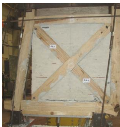
a) PA1: Rotura por esmagamento do nó inferior, com uma força de rotura de 60 kN
