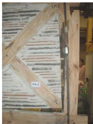
b) Rotura do prumo traccionado – secção cheia, com uma força de rotura de 63 kN
