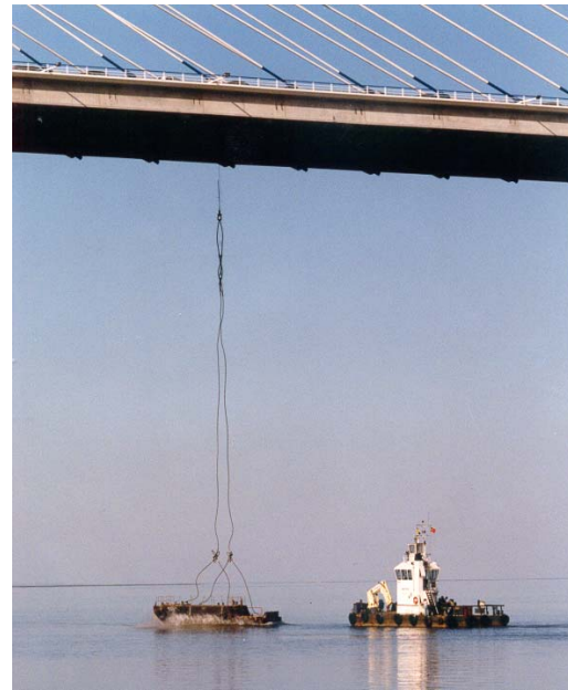
Fig. 3 – Ensaio de vibração livre na ponte Vasco da Gama
