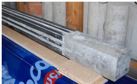
Fig 4 - Reforço dos pilares: (a) preparação do adesivo epoxídico; (b) aplicação dos laminados (extremidade superior); (c) aplicação dos laminados (extremidade inferior).
