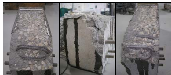
Fig 7 - Superfícies de rotura dos provetes ensaiados à flexão
