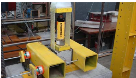
Fig 8 - Ensaio de corte com compressão lateral da ligação GFRP/betão
