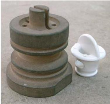
**Fig. 7** - Inserto em DM50 para molde de injeção de plástico (componente injectado à direita).
