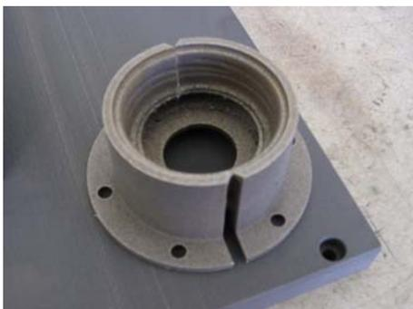
**Fig. 9** - Inserto em DS50 para molde de extrusão por sopragem de plástico.
