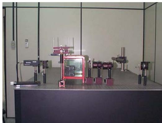
Fig. 11 - Montagem experimental utilizada na aplicação da holografia digital em condições submersas.
