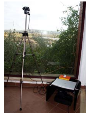
Fig 1- Equipamento do sistema de visão: câmara, lente, computador portátil, modem, router e UPS.
