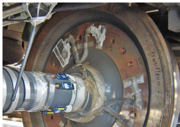
Fig. 4 - Roda com extensómetros devidamente isolados, módulos condicionadores e de telemetria, antenas emissora e receptora.
