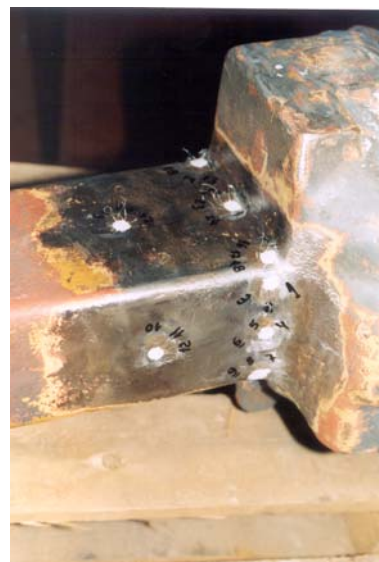
Fig 2 - Colagem de extensómetros no "lado direito" do engate.
