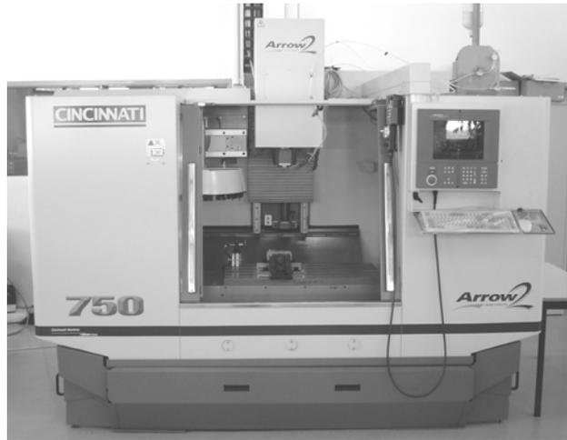
Fig 1 - Centro de maquinagem Cincinnati®, Arrow 750 utilizado nos ensaios
