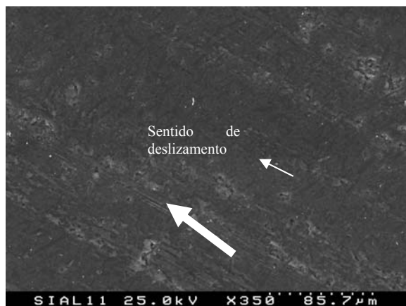
Fig 6 - Superfície de desgaste da amostra 30T1 evidenciando regiões com material aderente de aspecto escamoso, associado ao desenvolvimento de microfissuras perpendiculares à direção de deslizamento.
