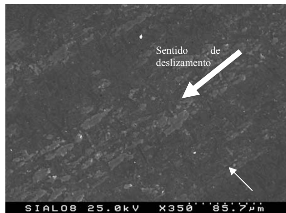
Fig 5 - Superfície de desgaste da amostra 20T1 evidenciando alguns vestígios de material aderente, decorrente de reações triboquímicas entre o pino e o disco, e uma região estriada na direção de deslizamento.
