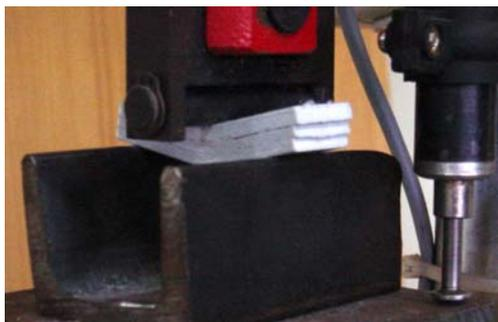
Fig. 7 – Rotura por corte interlaminar.
