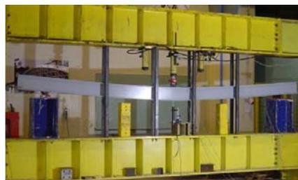
Fig. 4 – Ensaio à flexão de um perfil de GFRP.
