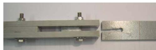
Fig. 17 – Rotura de uma das chapas de extremidade a ligar por corte local.
