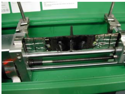
Fig. 6 - Ensaio de pelagem em provete de betume-polímero [13]
