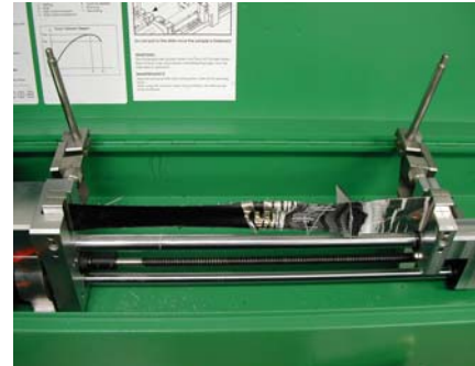
Fig. 7 - Ensaio de pelagem em provete de poliolefinas [13]
