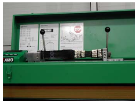
Fig. 3 - Ensaio de tracção-corte sobre provete de betume-polímero [13]
