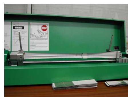
Fig. 4 - Ensaio de tracção-corte sobre provete de poliolefinas [13]
