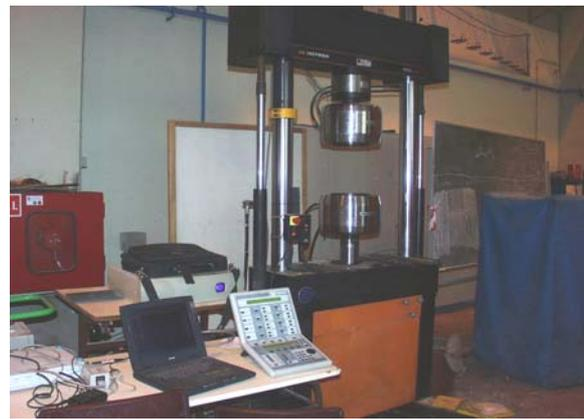
**Fig. 5** – Máquina de ensaios estáticos 'INSTRON'
