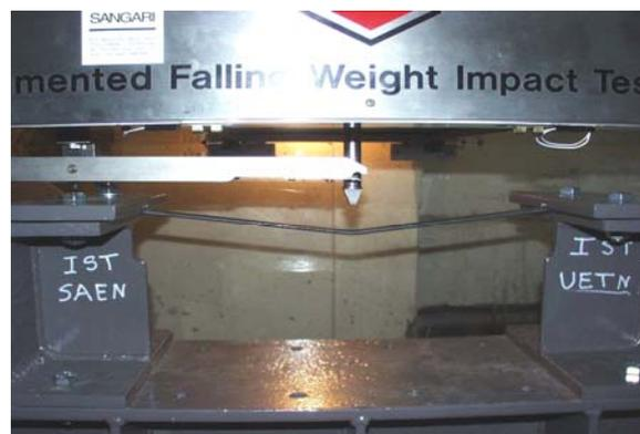
Fig. 1 - Vigas encastrada sujeitas a um impacto transversal.
