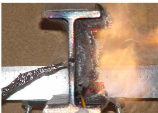
Fig 1 - Reacção da tinta intumescente.
