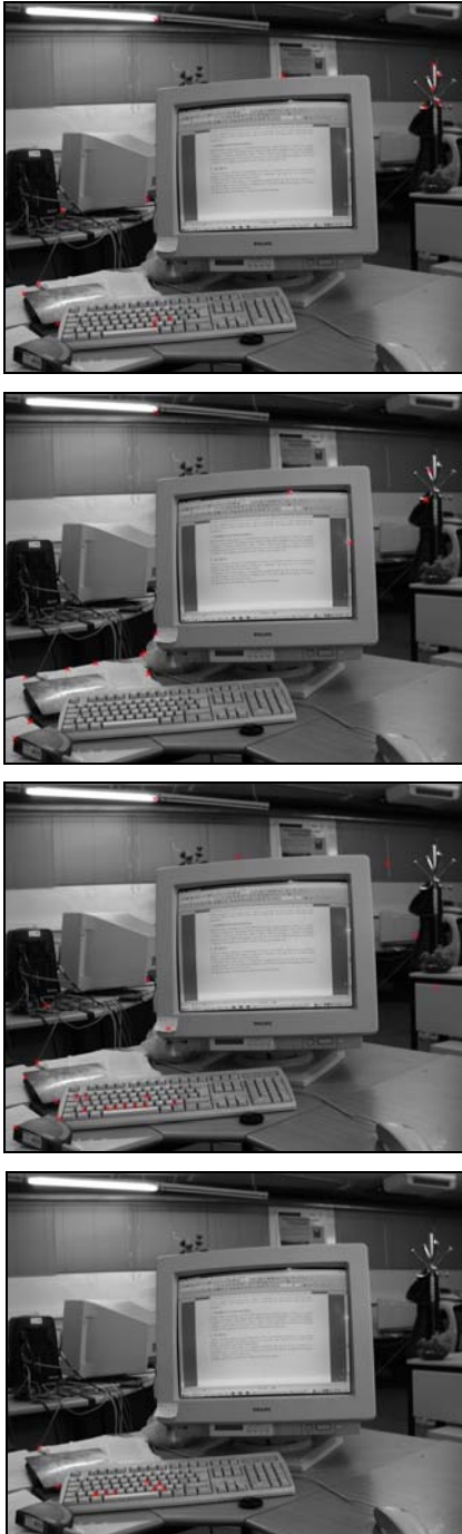
Fig. 7 - Resultado do emparelhamento dos pontos fortes, da Fig. 5, na outra imagem do par estéreo considerado: as cruzes a vermelho indicam os pontos emparelhados (de cima para baixo, são os resultados dos programas 1 a 4).
