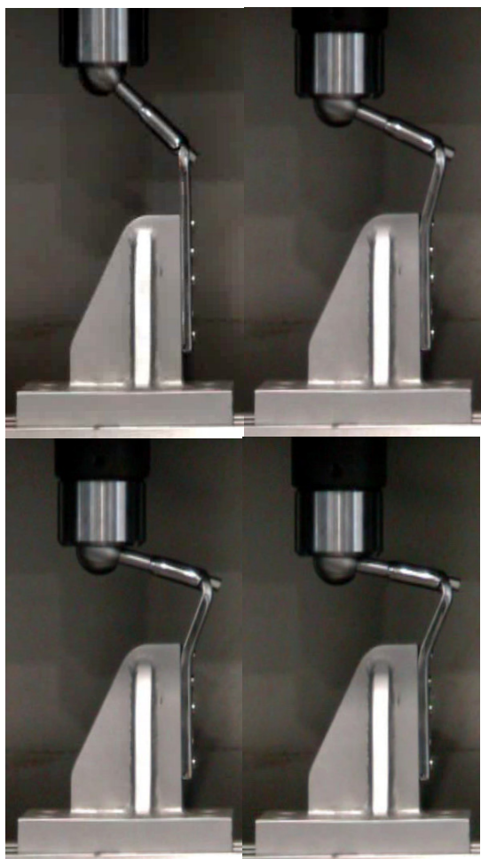
Fig 12 – Evolução da deformação da placa no decorrer de um ensaio.
