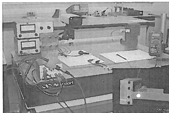
Fig. 5 - Montagem experimental da viga inteligente utilizada no controlo activo de vibrações e ponto de medição do transdutor laser .
