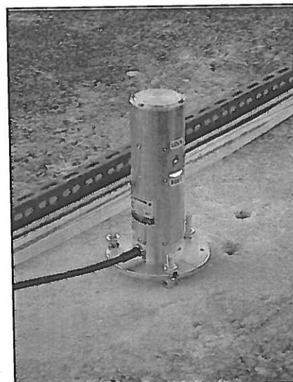
Fig 6: Inclinómetro eléctrico.
