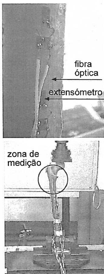
Fig 6 – Pormenor do extensómetro e da fibra colados na superfície do fémur sintético.
